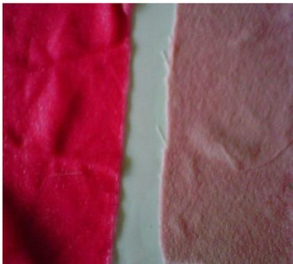
**Gambar 8.** Hasil Pencelupan Kain Selulosa (Kiri) dan Kain Poliester yang Dilapisi Selulosa Bakterial (Kanan)
